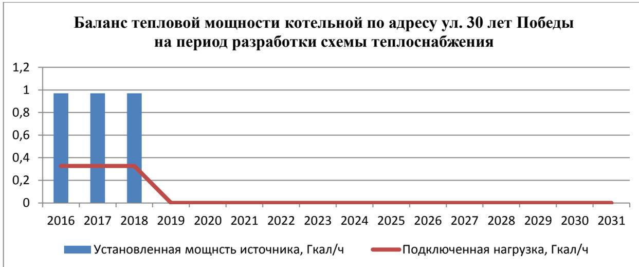
**Рисунок 21 Баланс тепловой мощности котельной по адресу: п.г.т. Раздольное, ул. 30 лет Победы**
